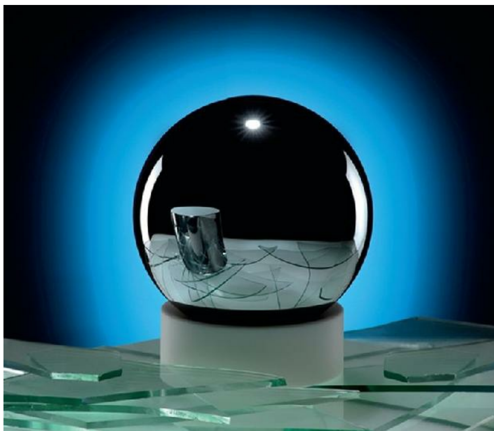
德国国家计量实验室制作的高纯度硅千克球，要拿来和几个国家的千克原器进行比较。 图片来源：德国国家计量实验室
