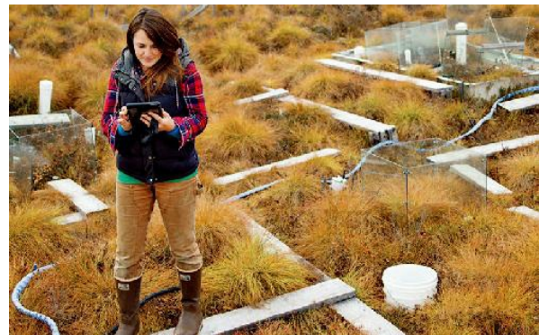
左图：在积雪覆盖的阿拉斯加山脉脚下，白色围隔内的传感器用于研究土壤吸收、释放的二氧化碳量。
