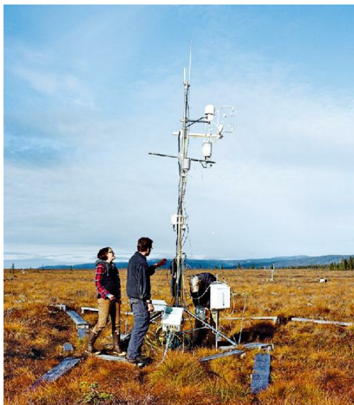
常年观测土壤和大气之间二氧化碳、甲烷交换的仪器塔，可以用于指示每年土壤生态系统的碳是净吸收还是净释放。
