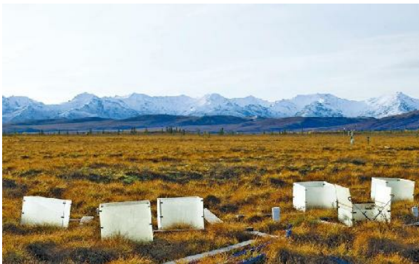
左图：在积雪覆盖的阿拉斯加山脉脚下，白色围隔内的传感器用于研究土壤吸收、释放的二氧化碳量。
