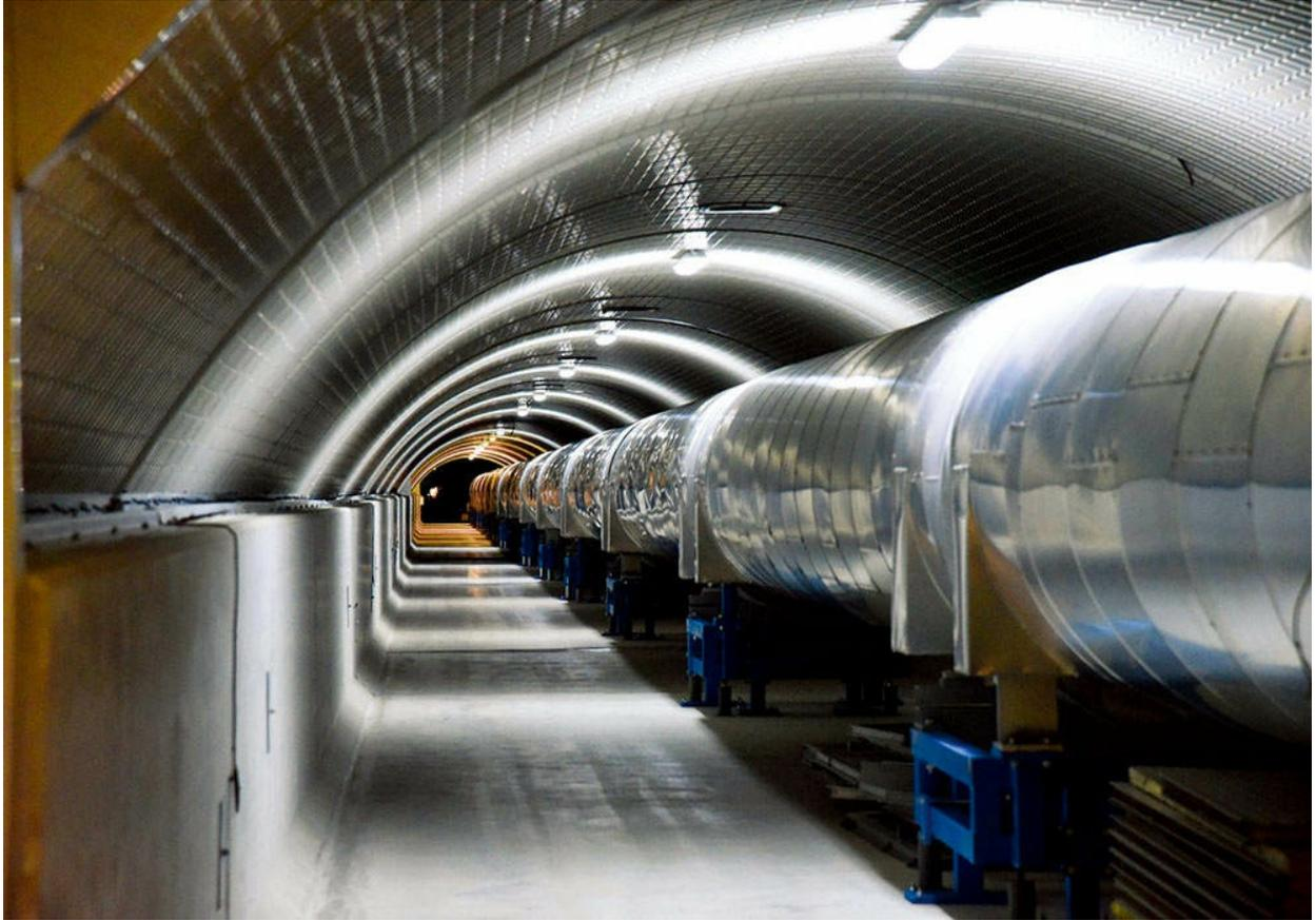
Virgo 成直角的双臂（图中仅显示了其中一支），每臂长逾3千米，在真空环境下运行，保证其中的光学系统不受干扰。这套系统对引力波造成的时空扭曲极为敏感。
